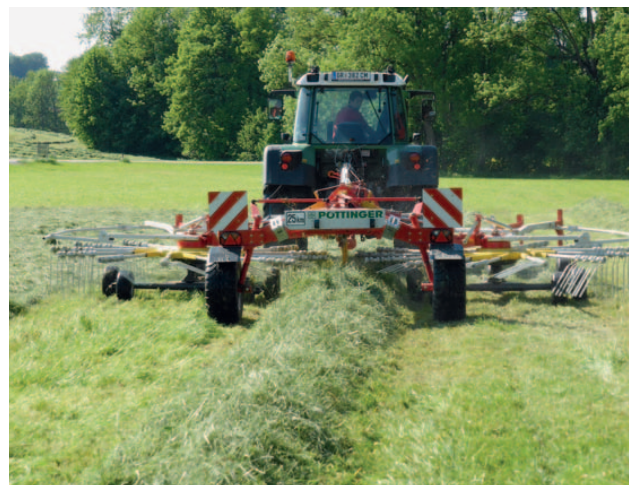
Bild 9: Vergleich Bodenanpassung auf kupiertem Gelände (Fahrgeschwindigkeit 8 km/h, Zapfwellendrehzahl 435 U/min, Abstand Boden-Zinken 32 mm, Standard = 5-Rad-Fahrwerk)
