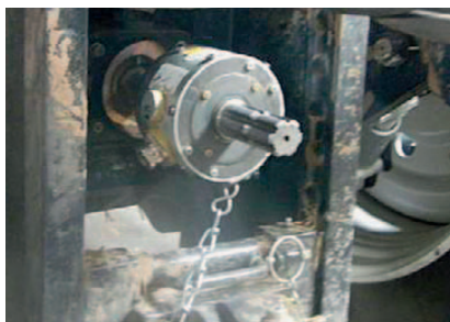
Bilder 5 und 6: Kistler Correvit L400 (links) und Walterscheid 2,5 kNm Messnabe (rechts)
