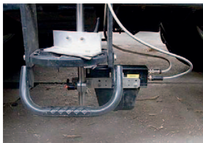
Bilder 5 und 6: Kistler Correvit L400 (links) und Walterscheid 2,5 kNm Messnabe (rechts)
